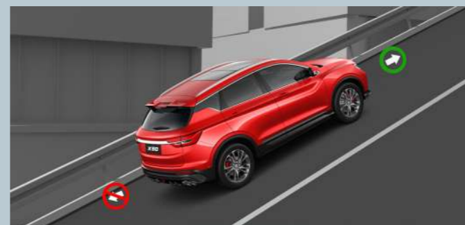
Система помощи при старте на подъеме (HNC)
