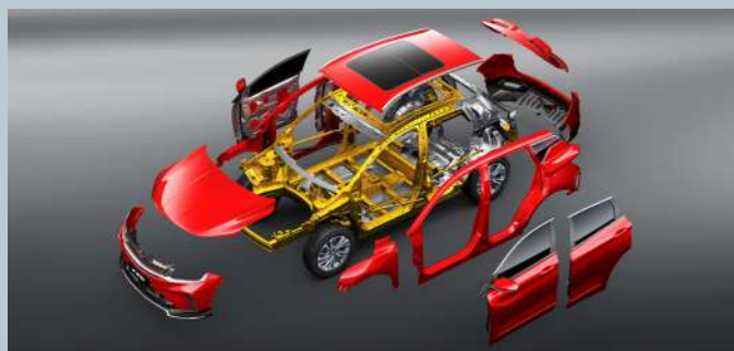
Кузов из высокопрочной стали
